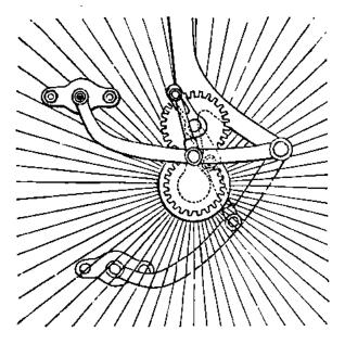
FIG. 39.-THE GRANVILLE GEARING.
