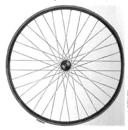
FIG. 28.-THE TRUE TANGENTIAL WHEEL
